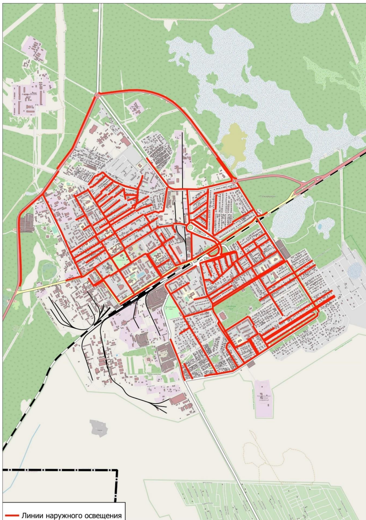
Рисунок 1.16 Расположение линий наружного освещения
