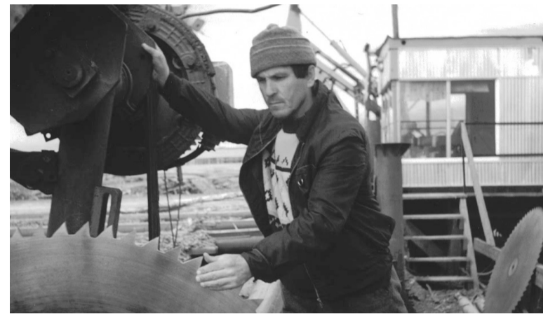
Перед началом работы необходимо было проверить остроту зубьев пилы.
